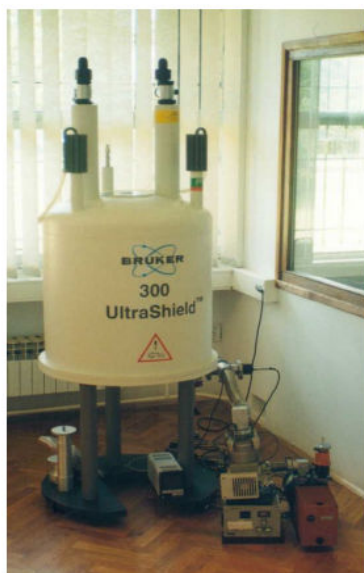
Slika 9. Uređaj Bruker Avance 300 MHz (lijevo) i cjevčica s otopljenim uzorkom (desno).
