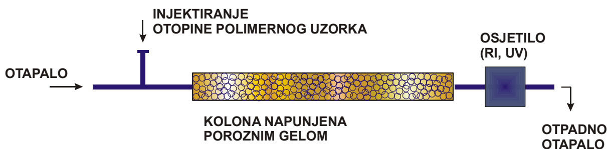
Slika 14. Skica SEC/GPC uređaja.
