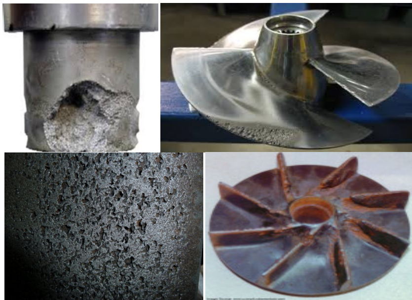
Slika 55. Oštećenja uzrokovana kavitacijom
