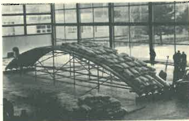
Sl. 44. Primjer opterećenja pri statičkom ispitivanju konstrukcija
