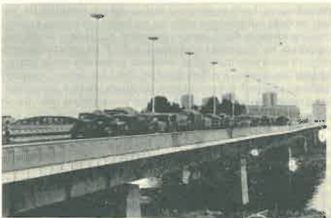
Sl. 46. Pokusno opterećenje mosta vozilima
